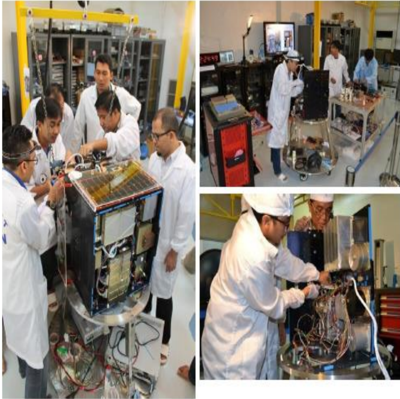
Proses Integrasi Satelit LAPAN A3
